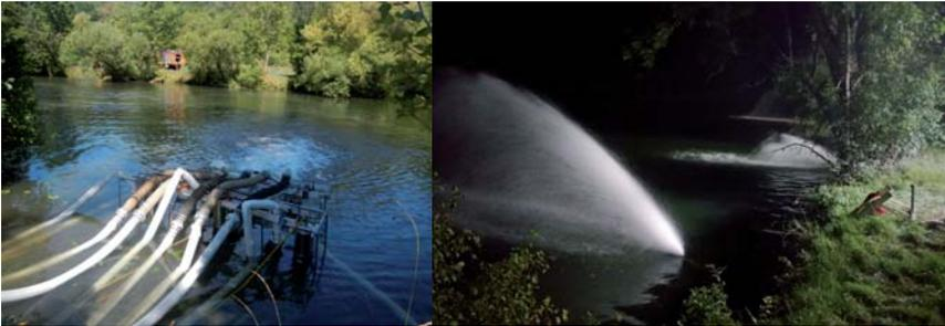
**Bild 2.7:** Belüftungsmaßnahmen an der Jagst durch das THW (Bilder der Ortsgruppen Offenburg und Überlingen)
