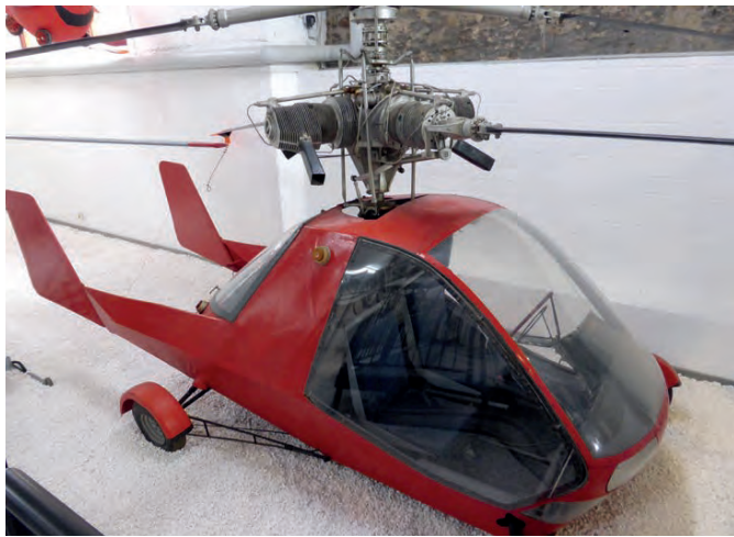
Der Wagner Rotocar von 1960 sollte die Systeme Hubschrauber und Auto miteinander kombinieren. Als Antrieb für die beiden Rotoren diente ein Dreizylinder-Sternumlaufmotor.
