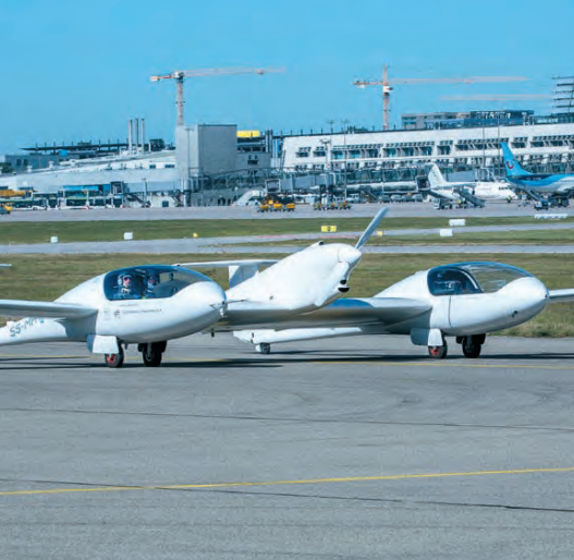
Die HY4 hat zwei Rümpfe, die über den Flügel fest miteinander verbunden sind. In jedem Rumpf haben zwei Passagiere Platz.
