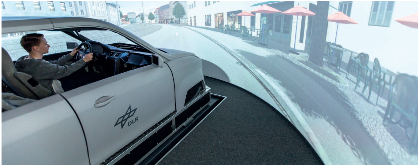
In einem sogenannten modularen Mock-up testet der Proband ein neues Fahrassistenzsystem und hat dabei vollen Rundumblick
