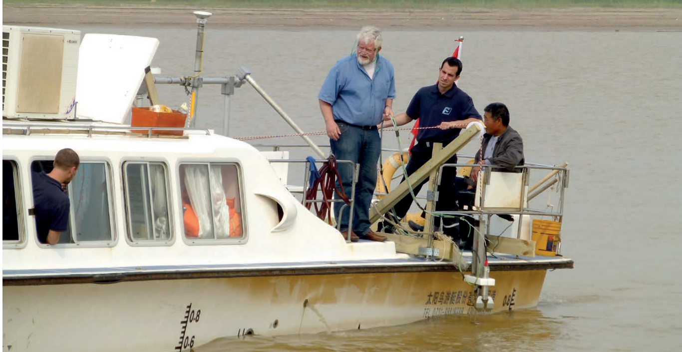
DELIGHT-Kooperationspartner vom Franzius-Institut der Universität Hannover und von der Firma Hydromod bei Messungen auf dem Gelben Fluss. Erfasst werden unter anderem Fließgeschwindigkeit und Sedimentkonzentration sowie Trübung und Salzgehalt.
