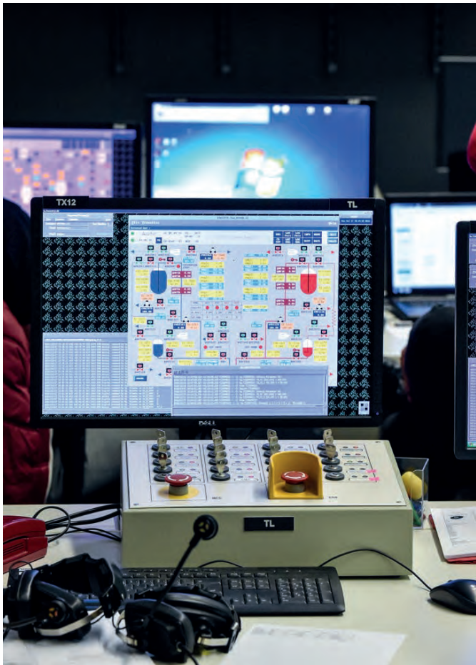
Der Platz des Versuchsleiters: Über Computerbildschirme wird der Test verfolgt und kann im Notfall abgebrochen werden.
