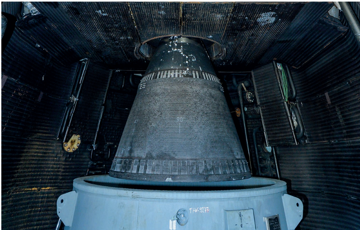
Mit Zündung des Triebwerks wird die grau-schwarze Düse in der Vakuumkammer beginnen, rot-orangefarben zu leuchten
