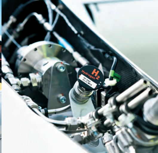
Der Antrieb: Wasserstoff wird in einer Brennstoffzelle in Strom umgewandelt. Der Elektromotor der HY4 hat eine Leistung von 80 Kilowatt.
