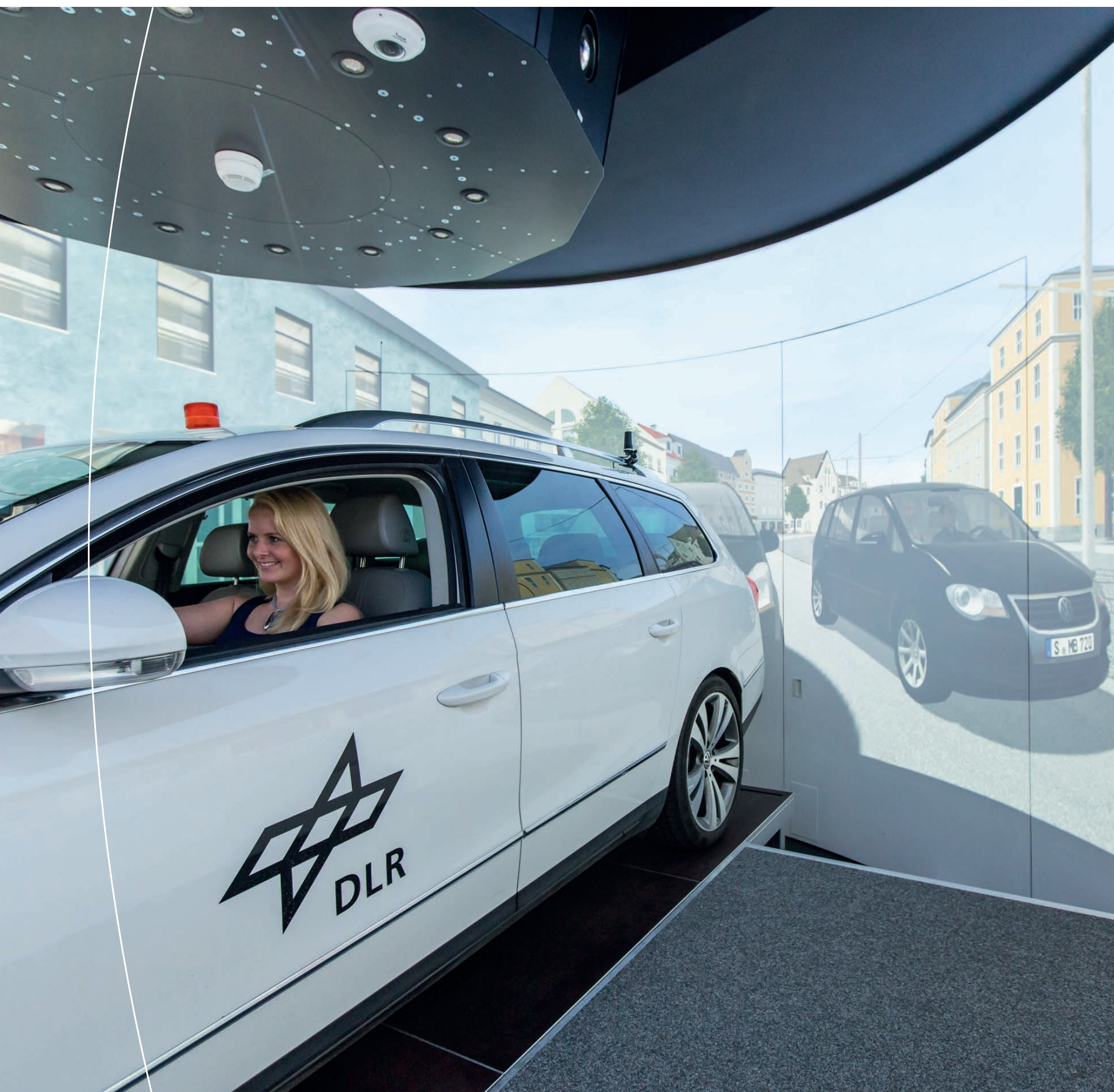
Fahrsimulation im Virtual-Reality-Labor des DLR: Eine 360-Grad-Darstellung der Umgebung vermittelt ein realitätsnahes Fahrgefühl.
