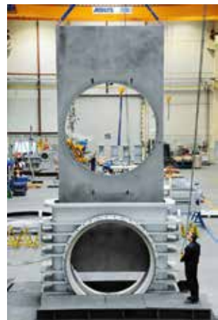
Montage eines 100" Doppelplatten Leitrohrschiebers.
