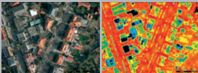
Aus 1.400 Meter Höhe aufgenommen: Thermofotografien, die zeigen, wo Energie gespart werden kann.
