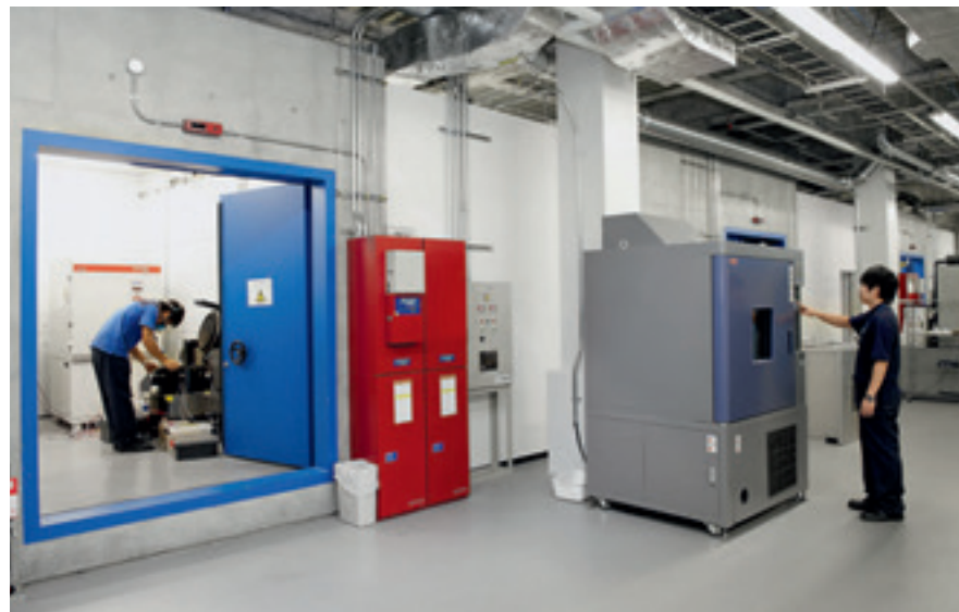
Vibration, Stoß, Überladung, abnormale Temperaturen, Feuchtigkeit oder Höhensimulation: In unseren drei Batterieprüflaboren führen wir Energiespeichersysteme gezielt an ihre Grenzen.
