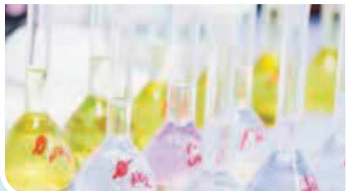
$\text{NH}_4$  steht für Ammonium,  $\text{NO}_2$  für Stickstoffdioxid. In Verbindung mit den Reagenzien färbt sich das Wasser und die Labormitarbeiter können den Gehalt der beiden Stoffe im Wasser ermitteln.
