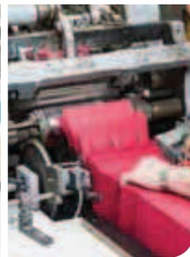
Dutzende Messer hängen griffbereit neben den Maschinen. Sie stanzen aus dem Papier die Grundform der Briefumschläge. Maschinell werden sie dann gefaltet und geklebt – unter wachsamen Augen.
