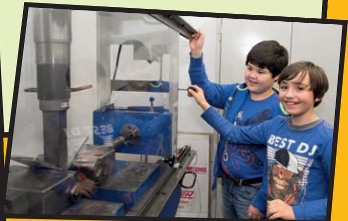
Per Knopfdruck lässt Florian einen Bolzen herunterfahren, der die Probe nach unten biegt.
