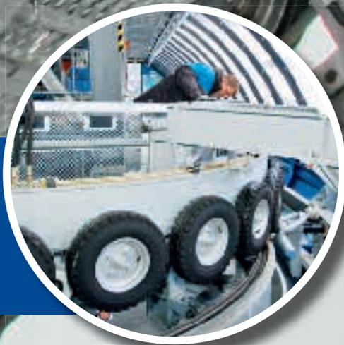
Blendenschalter, die die Verriegelung der Klemme auf dem Seil überwachen, werden genau überprüft.
