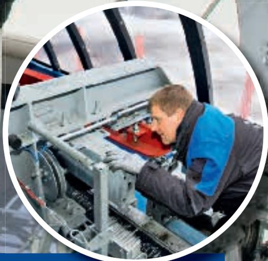
Die Klemmen, die den Sessel auf dem Seil halten, werden zerlegt und einzeln auf dem Klemmenprüfstand kontrolliert.
