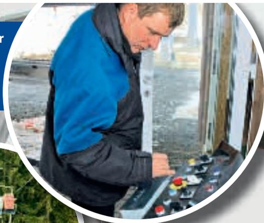
Für die Bremsproben werden die Sessel mit Lasten bis zu 640 Kilo beladen.
