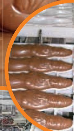
Die leere Formhälfte klappt auf die gefüllte Formhälfte und wird in die Rotationsanlage befördert. Dort drehen sie sich in alle Richtungen. Dabei fließt die Schokolade langsam an den Innenseiten der Formen entlang, erkaltet und wird fest. So entstehen Figuren, die innen hohl sind. Fachleute sagen dazu Hohlkörperfiguren. Anschließend heben Saugnapfe die fertigen Schokomänner vorsichtig auf ein Fließband.
