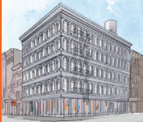
Das noch existierende Eckhaus in Manhattan gilt als Vorläufer der späteren Wolkenkratzer: Der Bau hat eine Struktur aus Eisenträgern und den ersten Otis-Aufzug mit Absturzsicherung.
