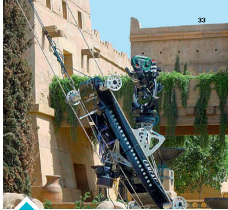
Der Kamerawagen, Buggy genannt, liegt auf zwei parallel gespannten Führungsseilen, entlang derer er über eine Strecke von bis zu 300 Metern gezogen werden kann.
