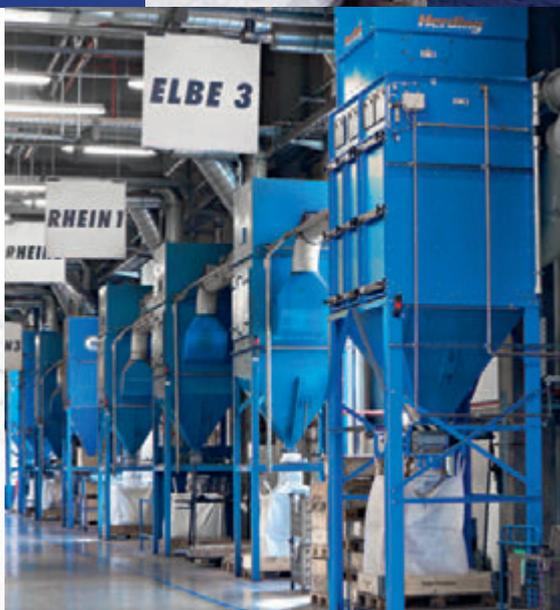
Leistungsstark: Jede Produktionslinie hat ihre eigene Filteranlage. Bis zu 170.000 m<sup>3</sup> Luft pro Stunde werden so von Staub gereinigt.
