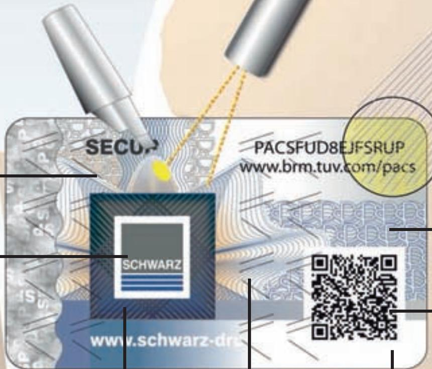
Indikation unsichtbarer Farbpigmente mittels speziellem Laserpointer
