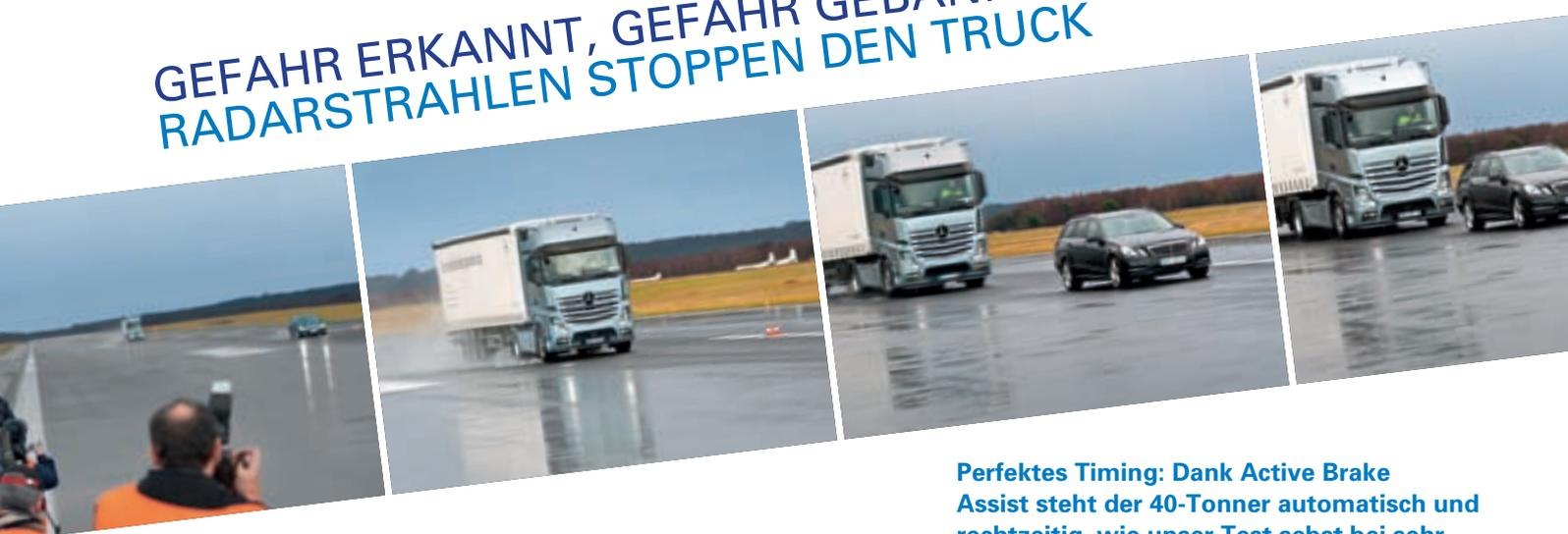
**Perfektes Timing: Dank Active Brake Assist steht der 40-Tonner automatisch und rechtzeitig, wie unser Test selbst bei sehr widrigen Witterungsbedingungen im Beisein von NRW-Verkehrsminister Harry K. Voigtberger beweist.**
