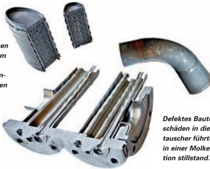
**Undichtes Rohr: Korrodierte Schweißnähte haben es aus dieser Kühlwasserleitung regnen lassen.**
