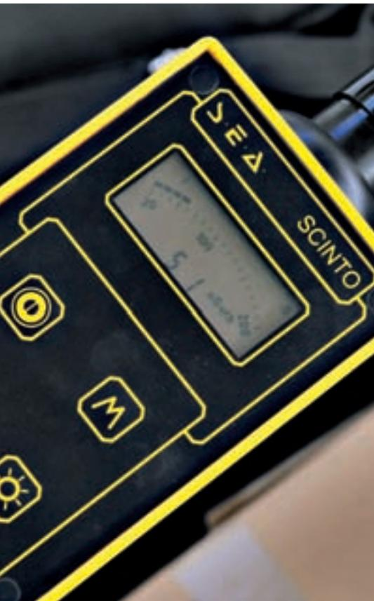
**Hilft den Experten, die ionisierende Strahlung genau zu messen: der Szintillationszähler.**
