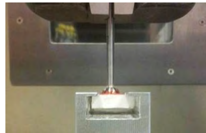
Abb. 2 Prüfling zur Identifizierung von Ablösungen zwischen syntaktischen Schaum und metallischer Elektrode eingespannt in eine Zugmaschine
