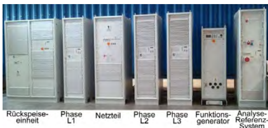
Abb. 4: Netzsimulator des IFHT Testzentrums
