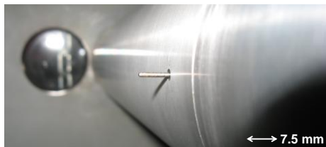
Abb. 2: Nadelelektrode zur Nachbildung einer Partikelstörung
