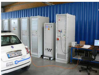
Abb. 1: Netzsimulator mit angeschlossenem Elektrofahrzeug
