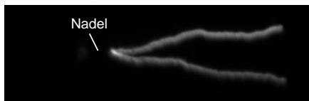
Abb. 5: Aufnahme des Durchschlagspfads
