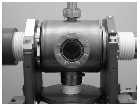
Abb. 1: Hochvakuum-pumpstand mit Modellschalter
