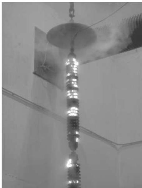
Fremdschichtüberschlag eines Stützers
