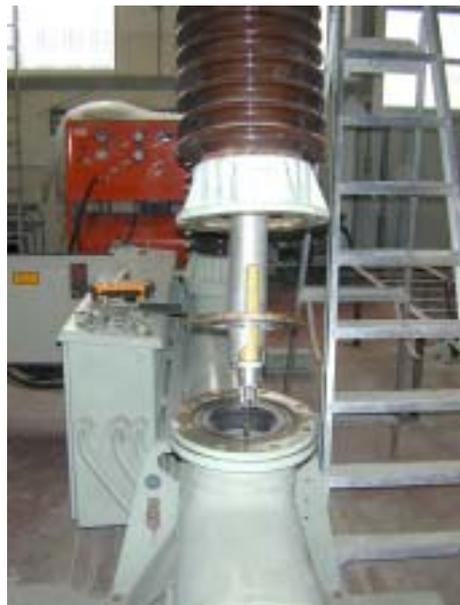
Abb. 1: Versuchsaufbau zu den künstlich eingeleiteten Defekten
