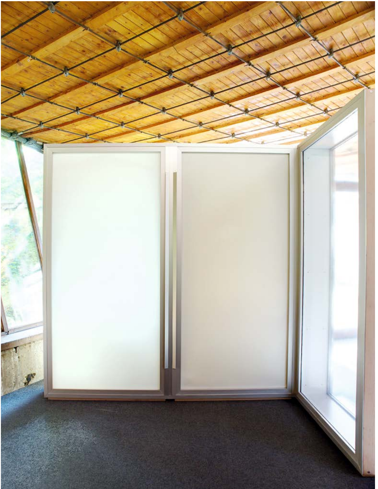
Abbildung 4: Testaufbau mit transluzentem, opakem und transparentem Fassadenelement
