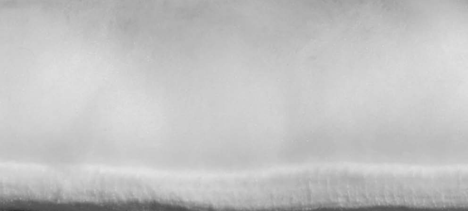
Abbildung 2: Schnittansicht des gradierten Verbundvliesstoffs
