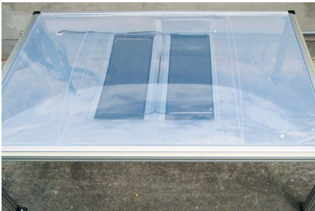
Freibewitterungsprüfstand des ETFE-Kissen-Prototyps mit innenliegenden PV-Modulen
