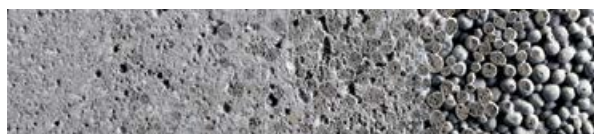
Geschichteter Porositätsgradient, Zuschlag (Blähglas), 4 x 4 x 16 Zentimeter
