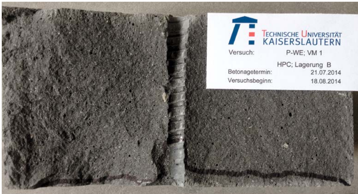
Hochfester Beton wurde auf Wasserundurchlässigkeit überprüft.
