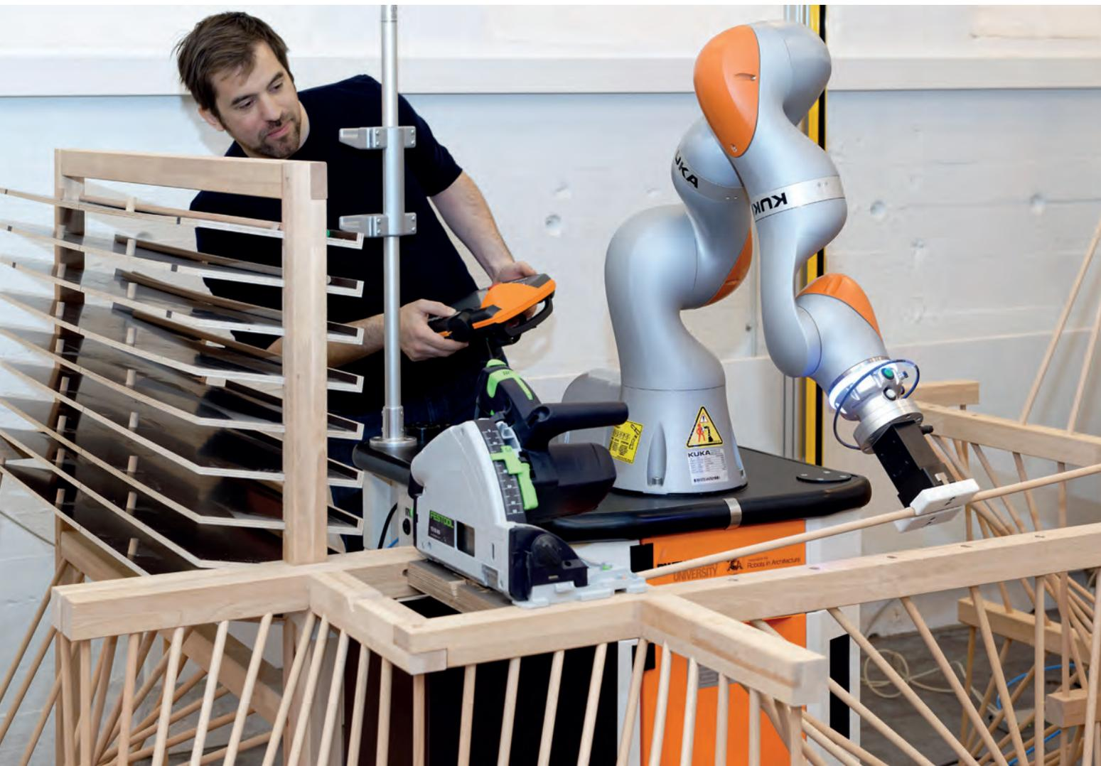
Bild 4: Neue Robotertechnik bearbeitet inhomogenes Material und montiert individuelle Bauteile mit hohen Bautoleranzen ohne Bilderkennung oder zusätzliche Sensorik.
