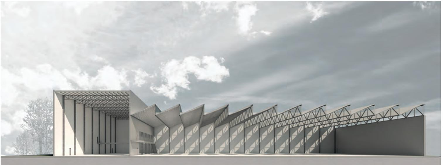
Bild 2: Anordnung von Oberlichtern in der Dachebene zur natürlichen Belichtung des Innenraums und als Träger von geneigten Solarpaneelen.
