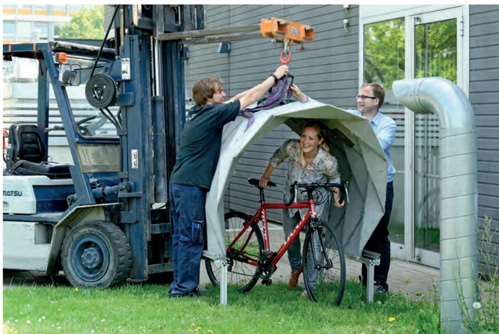
Bild 1/2: Oricrete: Origami im Bauwesen am Beispiel einer Textilbetonfaltwerkschale.
