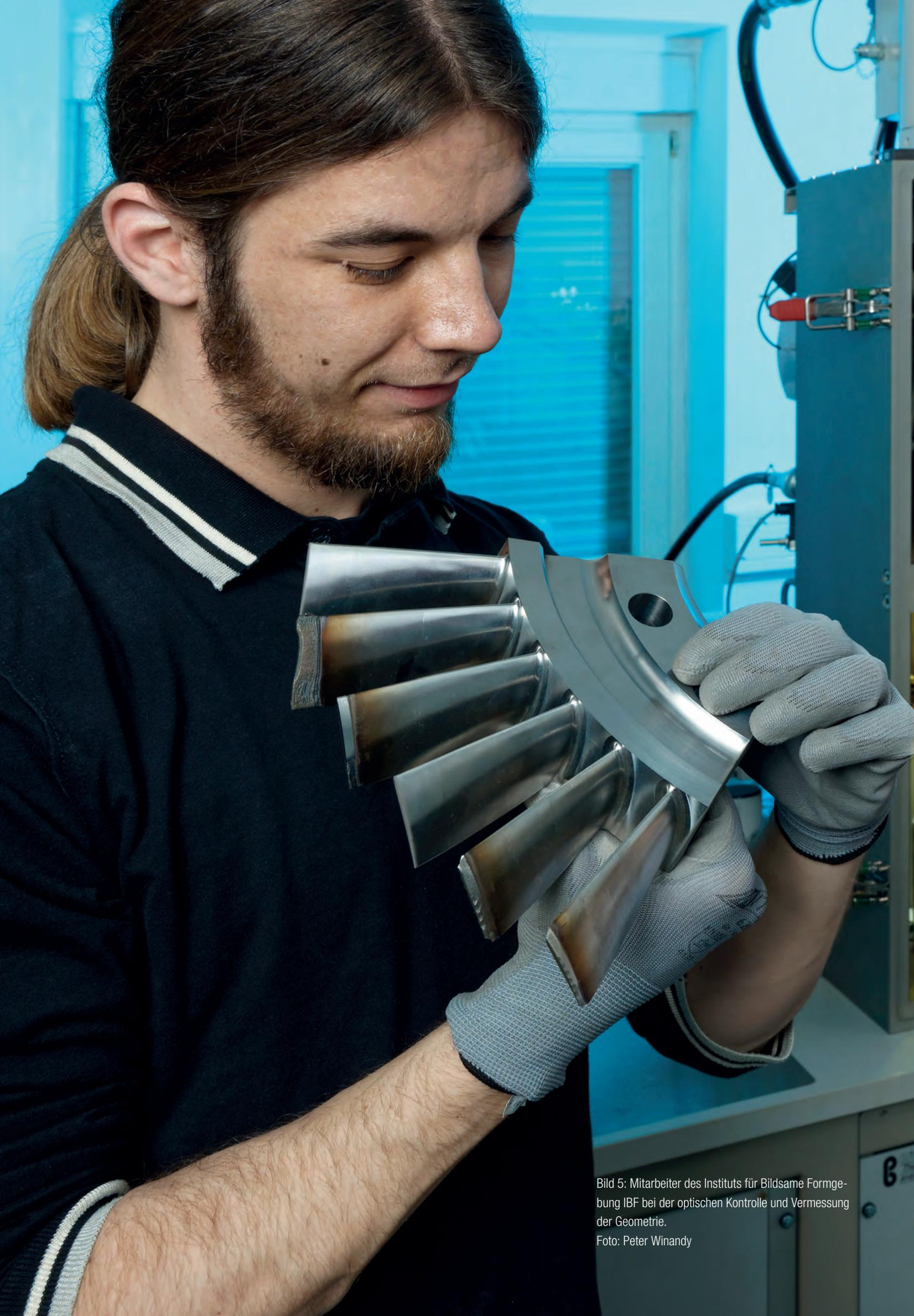
Bild 5: Mitarbeiter des Instituts für Bildsame Formgebung IBF bei der optischen Kontrolle und Vermessung der Geometrie.
