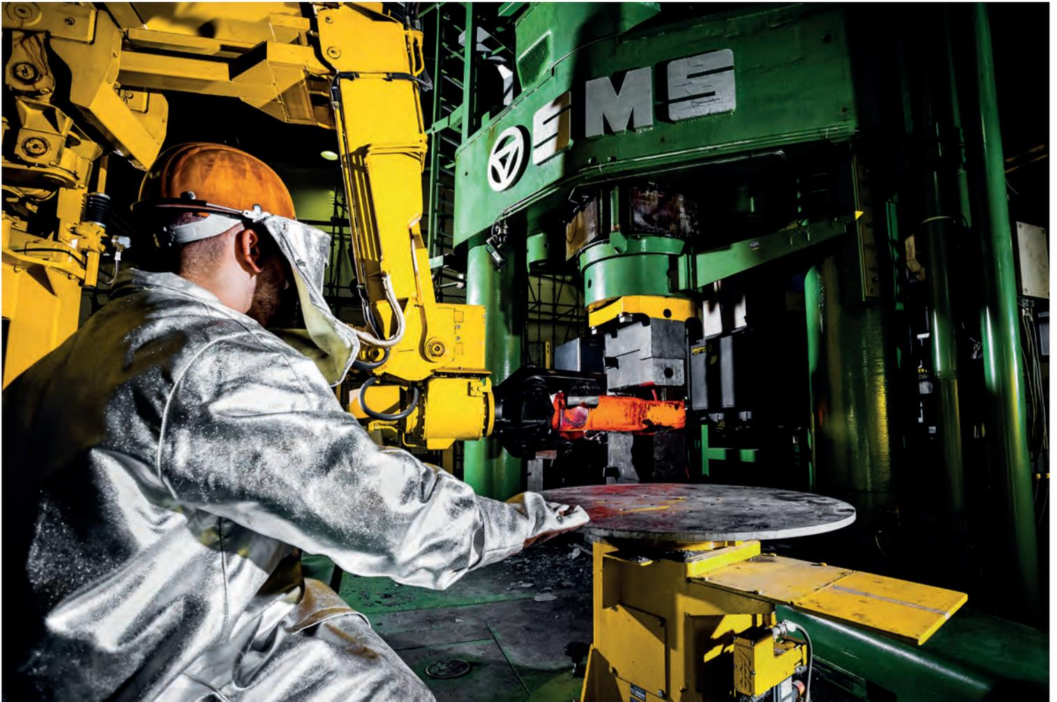
Bild 2: Freiformschmieden eines Blocks auf der 630-Tonnen-Pressen des Instituts für Bildsame Formgebung IBF. Foto: Martin Braun
