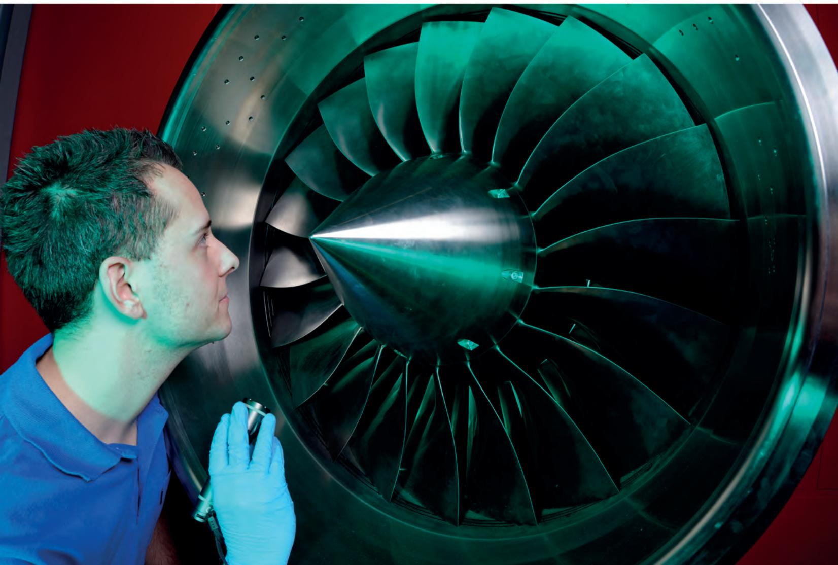
Bild 1: Der Fan ist eines der wichtigsten Komponenten für den Schub des Triebwerkes. Foto: Peter Winandy
