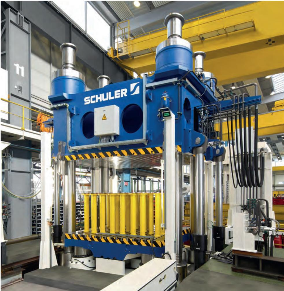
Bild 1: Das Aachener Zentrum für integrativen Leichtbau AZL baut derzeit eine 1.800-Tonnen-Composite-Pressen der Schuler Pressen GmbH im Cluster Produktionstechnik auf.
