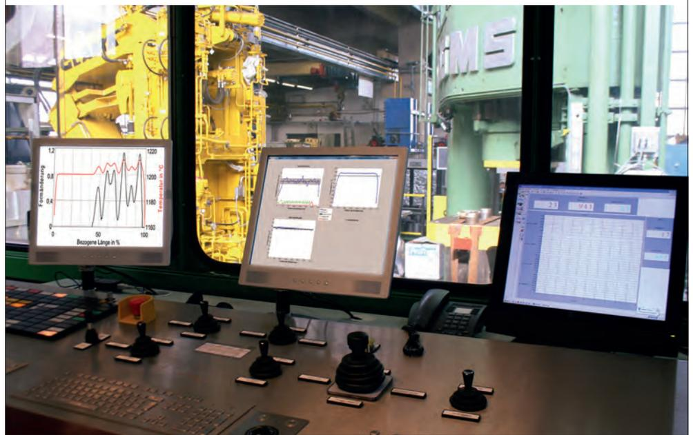
Bild 3: Konzept eines Assistenzsystems für einen Pressenbediener und mögliche Umsetzung an der Schmiedepresse des Instituts für Bildsame Formgebung IBF.
