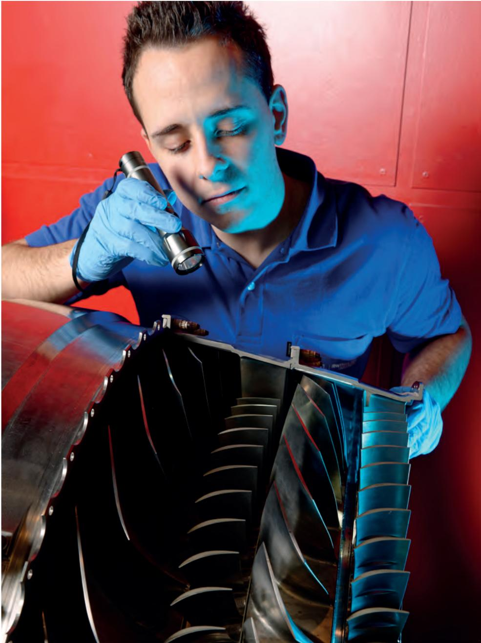
Bild 3: Visuelle Prüfung der Oberflächenqualität einer Verdichterstufe. Foto: Peter Winandy
