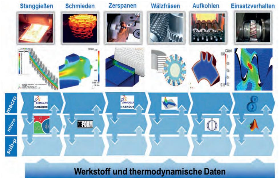
Bild 1: Grafische Darstellung einer ICME Plattform (AixViPMaP) für die Zahnradfertigung mit skalenübergreifenden numerischen Simulation entlang der Prozesskette.
