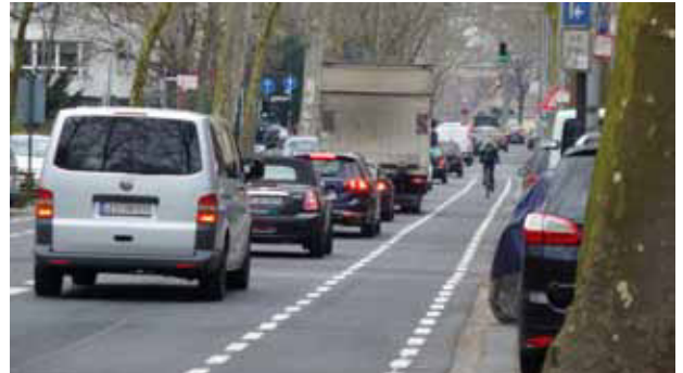
Vorgebirgsstraße: Ein Schutzstreifen erhöht die Sicherheit für Radfahrer auf dem hoch verkehrsbelasteten Abschnitt zwischen Volksgarten und Ringen.
