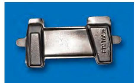
Rissfreie, geschmiedete FeAl-Schaufel (korngefeinertes Gefüge).
