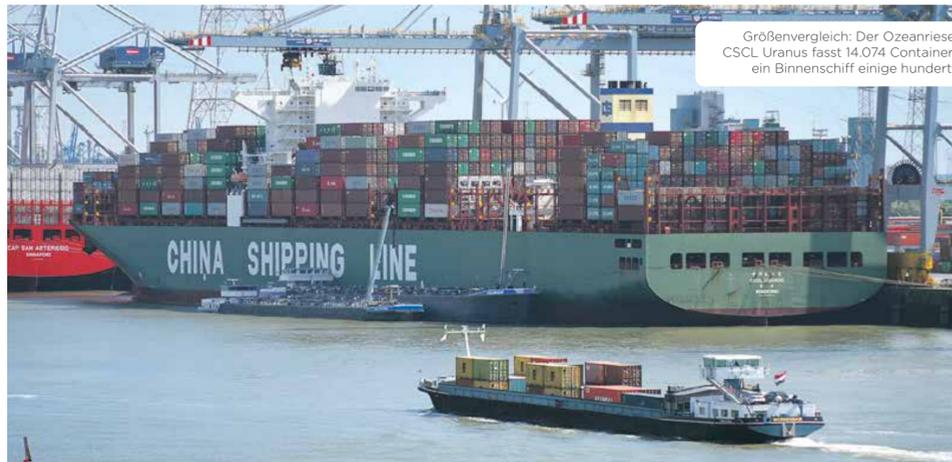
Größenvergleich: Der Ozeanriese CSCL Uranus fasst 14.074 Container, ein Binnenschiff einige hundert.
