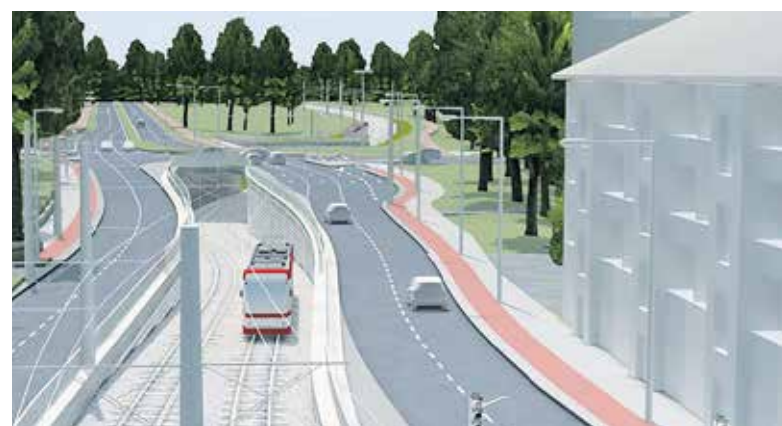
Die Visualisierung zeigt, wie die Linie 18 künftig im Tunnel unter der Straßenkreuzung hindurchgeführt werden soll.
