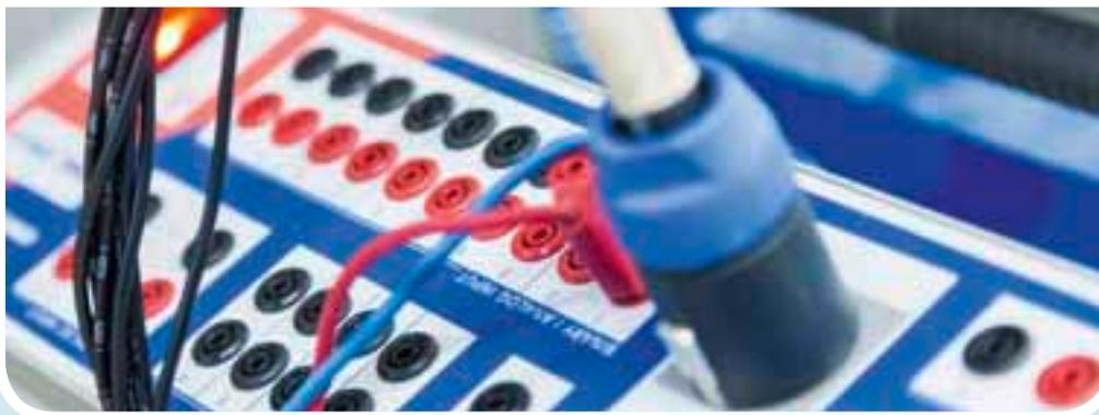
Mit dem Messkoffer simulieren die beiden Kollegen die Netzspannung, können so verschiedene Szenarien durchspielen und Lösungen dafür entwickeln, ohne den Netzbetrieb zu stören.
