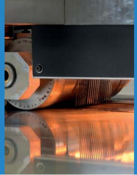
durch beliebig einstellbare Faserorientierungen genau an den jeweiligen Anwendungsfall und die gewünschte Belastbarkeit anpassen. Damit gelingt erstmals eine vollständig automatisierte Herstellung belastungs- und verschnittoptimierter Organobleche einschließlich Umformung, Funktionalisierung und Besäumung.
