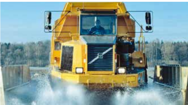
Reifenwaschanlage (Foto: FRUTIGER Company AG)
