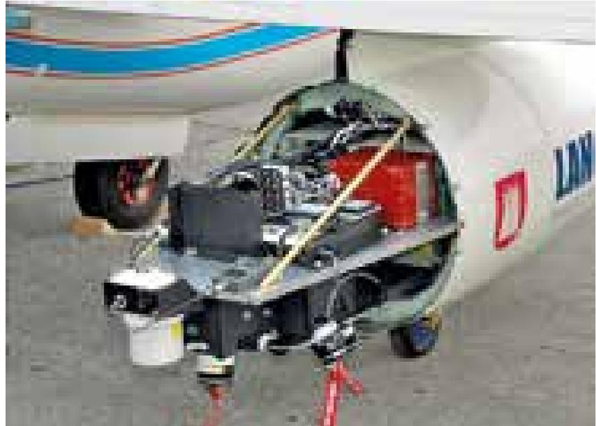
Kamerasystem unter der Tragfläche des DLR-Motorseglers Antares
