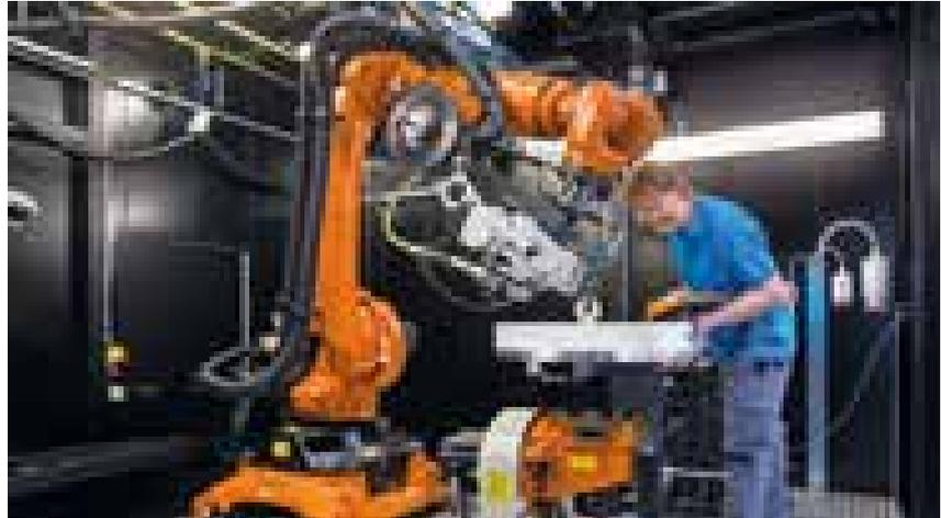
Vorbereitung der DLR-Tapelegemaschine für den Einsatz
