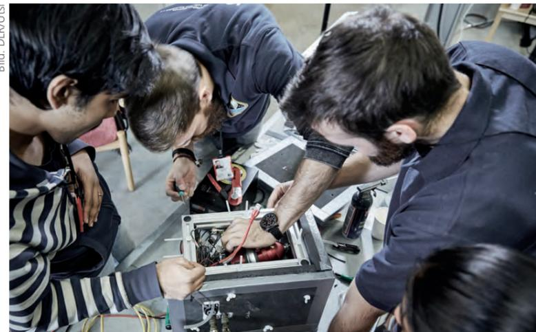
Um während der Tests besser an die Elektronik von COSPA zu gelangen, ist das Gehäuse bis zum Countdown noch teilweise geöffnet
