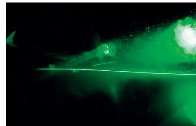
Während des Messfluges: Strömungswirbel im Laser-Lichtschnitt
