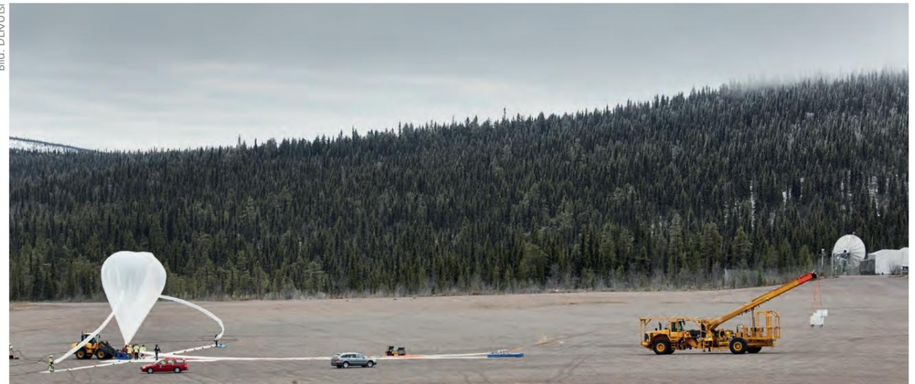
Das Befüllen des Ballons mit Helium dauert etwa zehn Minuten. Dann erhebt sich der Ballontrain und das Startfahrzeug Hercules (rechts im Bild) gibt die Nutzlast frei.
