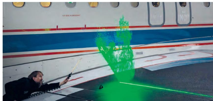
Lasermessungen über der Tragfläche während der Vorbereitung auf nächtliche Flugversuche
