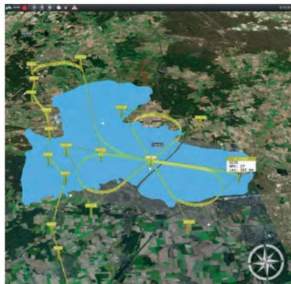
Missionsplanung und Fernführung der D-CODE mit der Bodenstation für unbemannte Luftfahrzeuge U-FLY
