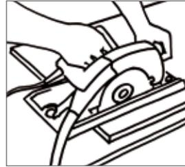
*Abb. 225: Zuschneiden der Einzelteile des Regals mit Handmaschinen*
