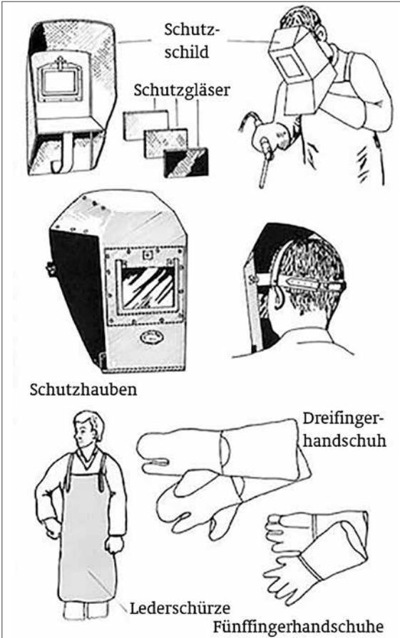
Abb. 169: Schweißerschutzschild und Schweißerschutzkleidung
