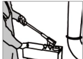
Abb. 145: Dichtheitsprüfung von Sanitärbauteil
