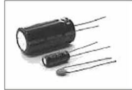
Abb. 195: Kondensatoren
