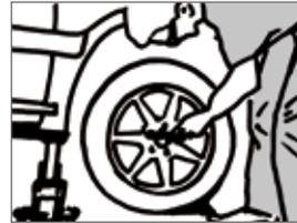
Abb. 78: Entfernen der Radmuttern
