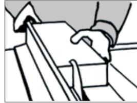
Abb. 64: Beistell-Lehre an der Formatkreissäge
