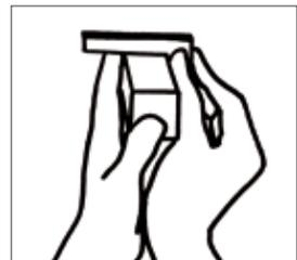
Abb. 228: Prüfen der Oberflächengüte durch das Lichtspaltverfahren
