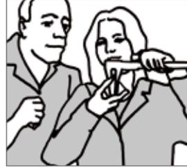
Abb. 229: Prüfen der Maßhaltigkeit einer Arbeitsprobe
