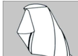
Abb. 108: Ausgespitzter Bohrer
