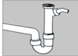
Abb. 135: Vormontieren des Siphon
