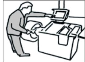
Abb. 81: Auswuchten des Reifens mit der Maschine
