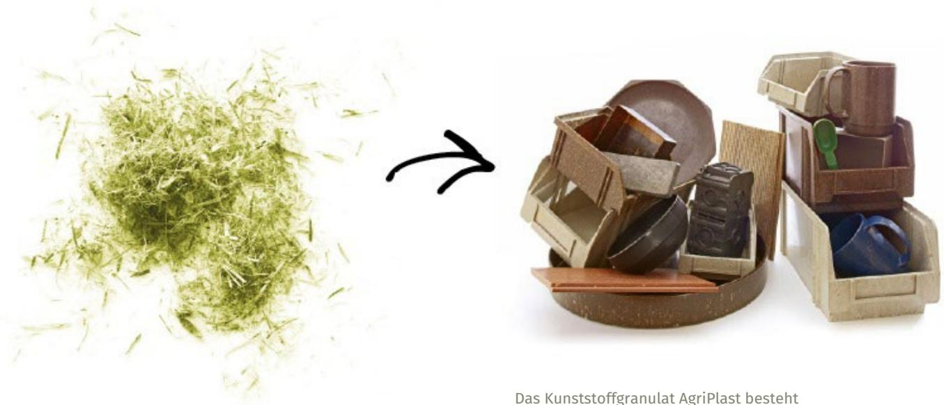
Das Kunststoffgranulat AgriPlast besteht überwiegend aus Grasfasern.
