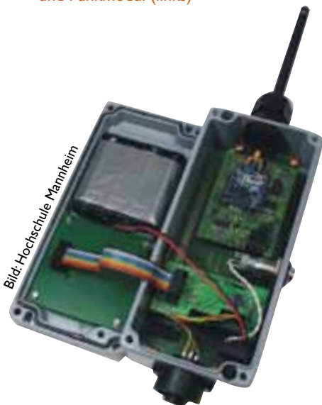
Abb.: Multiparametersensor (rechts) und Funkmodul (links)
