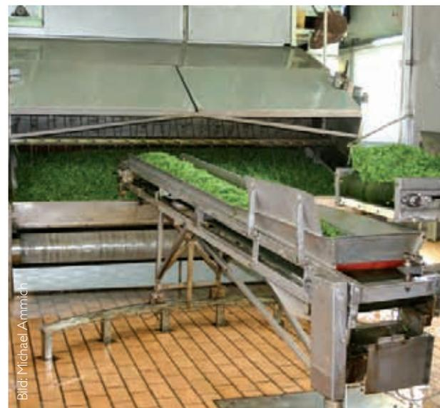
In der Trocknungsanlage der ESG Kräuter GmbH können täglich bis zu 800 t Petersilie, Dill oder Schnittlauch verarbeitet werden.
