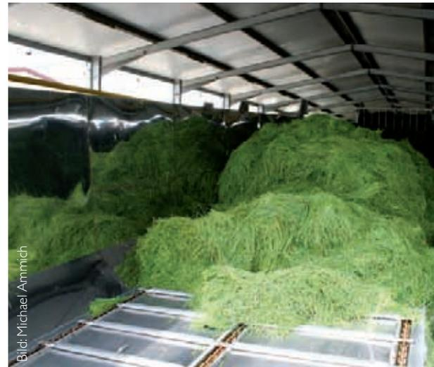
Über große Dosierer gelangen die feldfrischen Kräuter aus den Transportanhängern ohne Bodenkontakt in die Trocknungsanlage.
