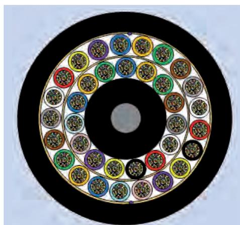
Für die Verwendung von Glasfasern in Breitbandnetzen werden die Fasern in Bündeladern zusammengefasst (2–24 Fasern). Diese können zu mehreren zusammengefasst werden, sodass Kabelkonstruktionen mit bis zu 864 Fasern möglich sind.
