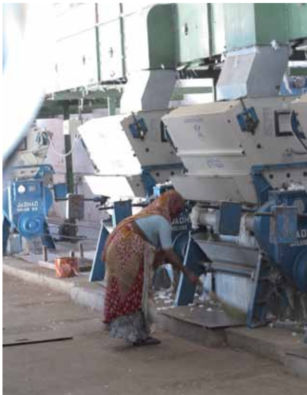
Arbeiterin an den Entkernungsmaschinen, Foto: Berndt Hinzmann
