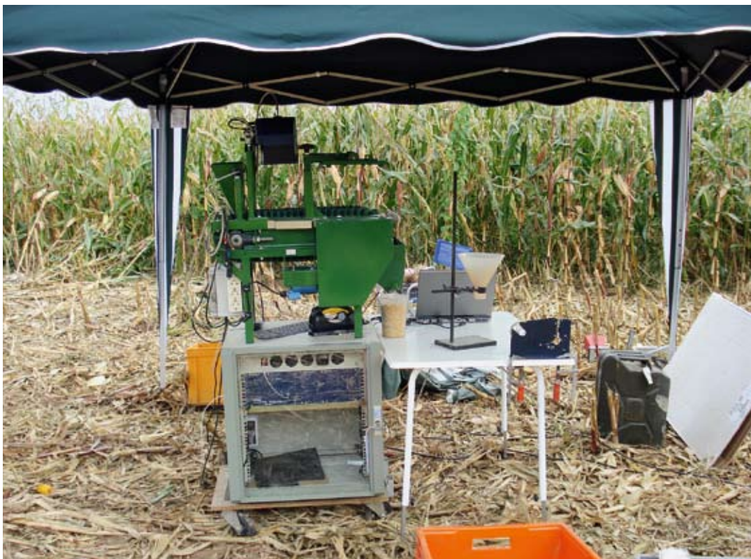
Hintereinanderschaltung von mobilen NIRS-Messstationen für einen Gerätevergleich
