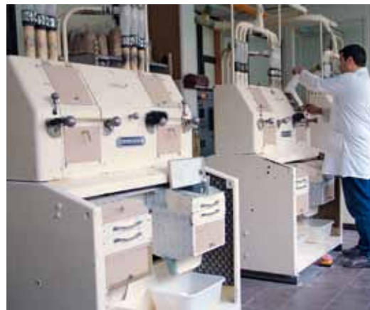
Kleintechnischer Walzenstuhl der Firma Bühler-AG, Uzwil, Schweiz zur Herstellung von Weizen-Typenmehlen
