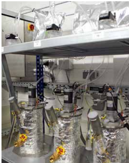
Laborfermenter: Drei kontinuierlich betriebene Biogasreaktoren im 5 Liter- Maßstab
