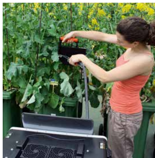
Methoden wie die Terahertz-Technologie werden zur Selektion von Genotypen mit besonders guter Trockenstresstoleranz eingesetzt.
