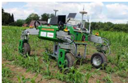
Feldphänotypisierung mit dem BoniRob, entwickelt an der Hochschule Osnabrück
