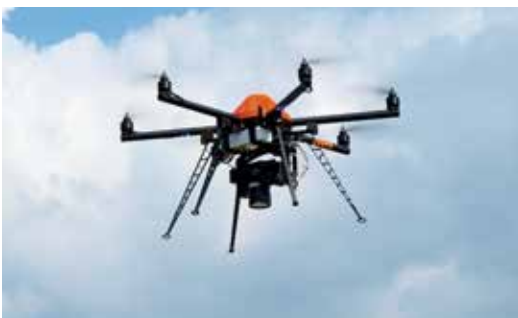
Entwicklung unbemannter Sensorplattformen zur Bonitierung von Pflanzenbeständen aus der Luft, hier ein Hexacopter mit Multispektralkamera der Universität der Bundeswehr München
