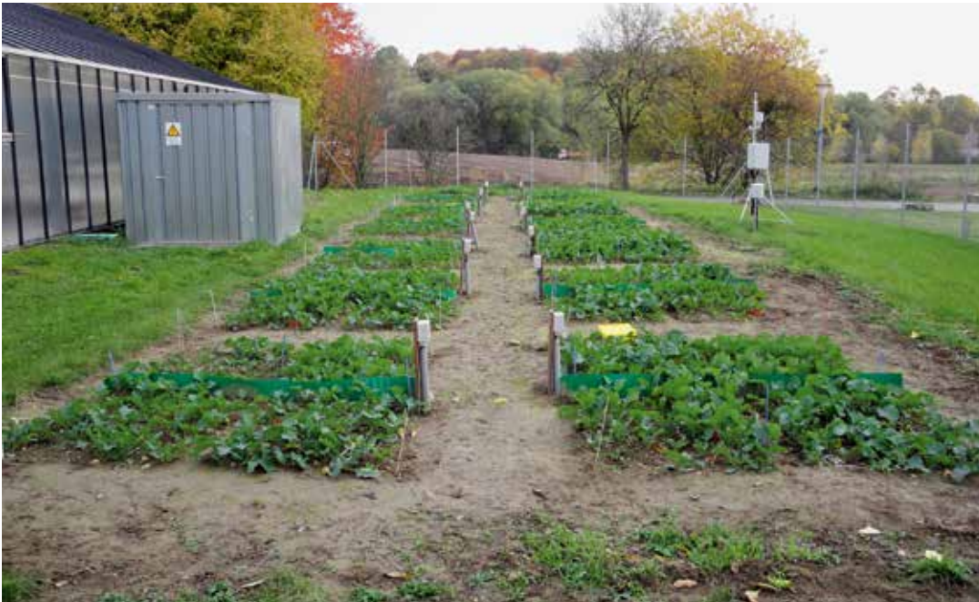
Göttinger Bodenerwärmungsanlage zur Überprüfung der Auswirkungen des Klimawandels auf bodenbürtige Stadien von Phoma lingam
