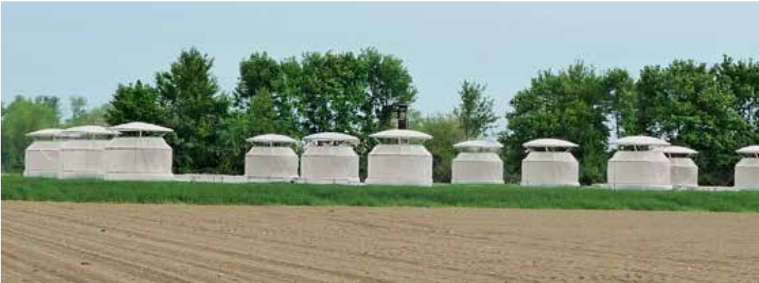
Gerstenpflanzen werden in Feld-Expositionskammern erhöhten CO 2 -Konzentrationen ausgesetzt, um einen Düngeeffekt festzustellen.
