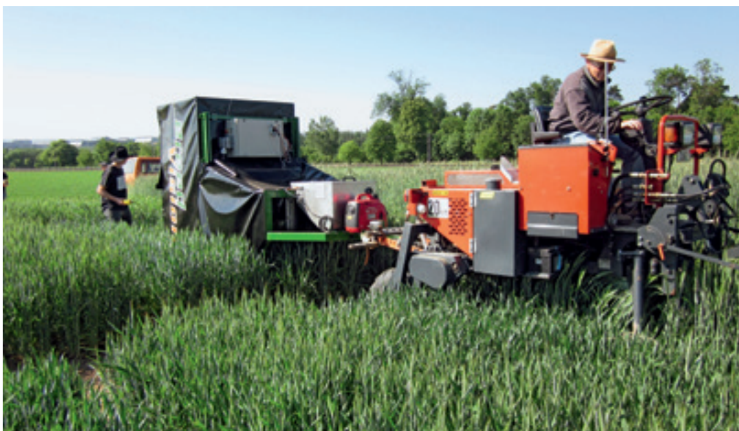
Phänotypisierungsplattform bei einer Messfahrt im Winterweizen
