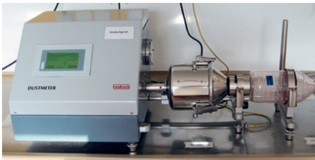
Bestimmung des Abriebs von Beizmitteln mittels Heubach-Methode
