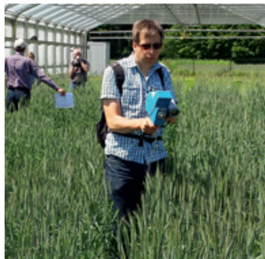
Bestandestemperaturmessungen mit Infrarotthermometern und Wärmebildkamera im Rain-out Shelter
