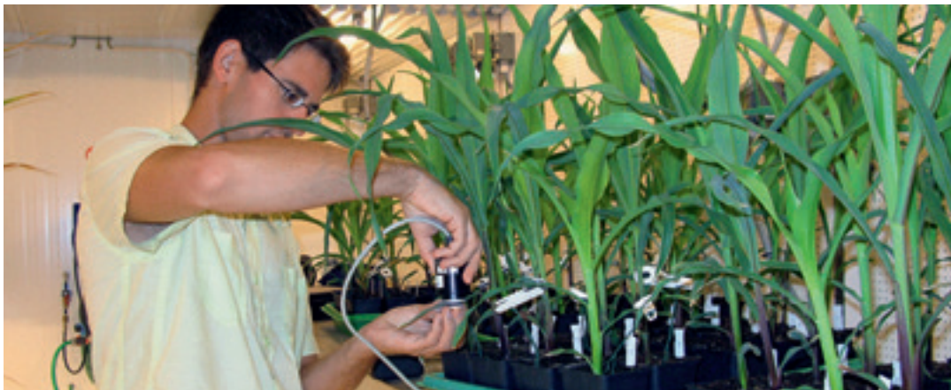
Messung der Effizienz des Photosystems an Mais mit Fluorometer
