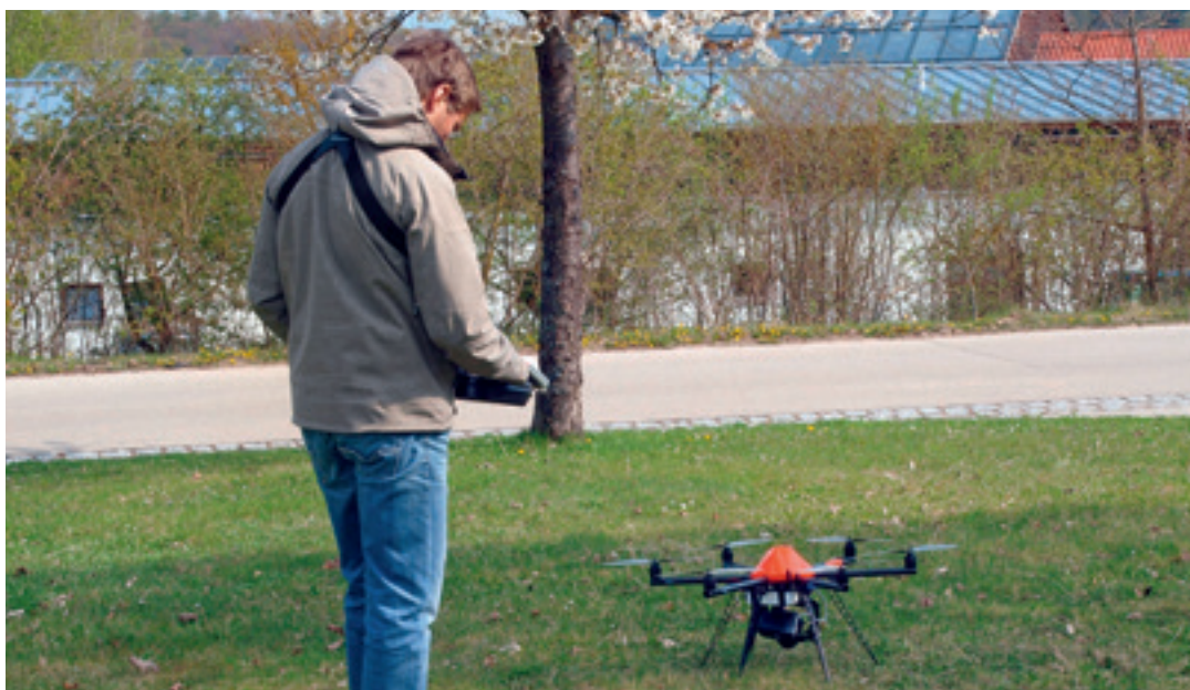
Hexacopter mit Multispektral- kamera zur Bonitierung von Pflanzenbeständen
