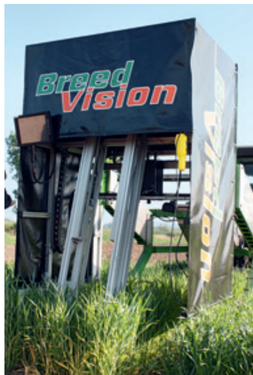
Phänotypisierungsplattform bei einer Messfahrt im Winterweizen
