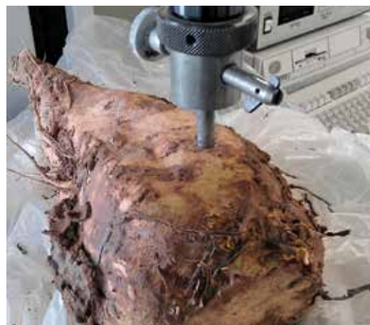
Zuckerrübe im Stempeltest zur Ermittlung der Epidermisfestigkeit
