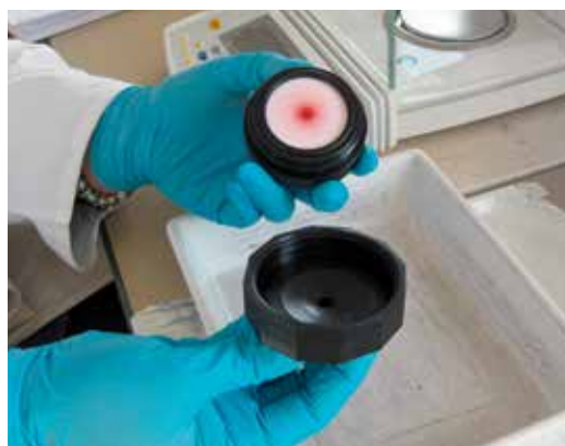
Staubfilter aus einem Heubach-Messgerät
