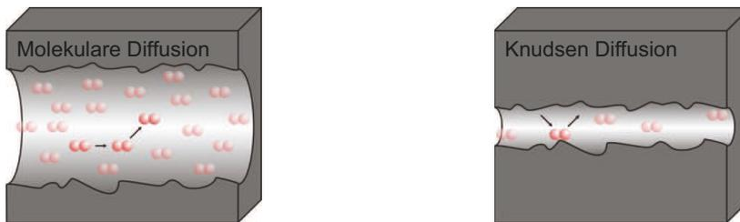
Abbildung 3.10: Vereinfachte Darstellung des Unterschiedes zwischen Knudsen- und molekularer Diffusion [42]
