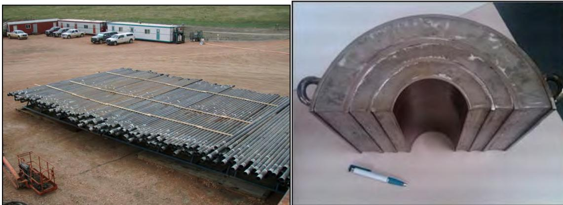
Abb. 4.1.5 Casingrohre vor dem Einbau und Schnitt durch einen Bohrungsabschnitt
