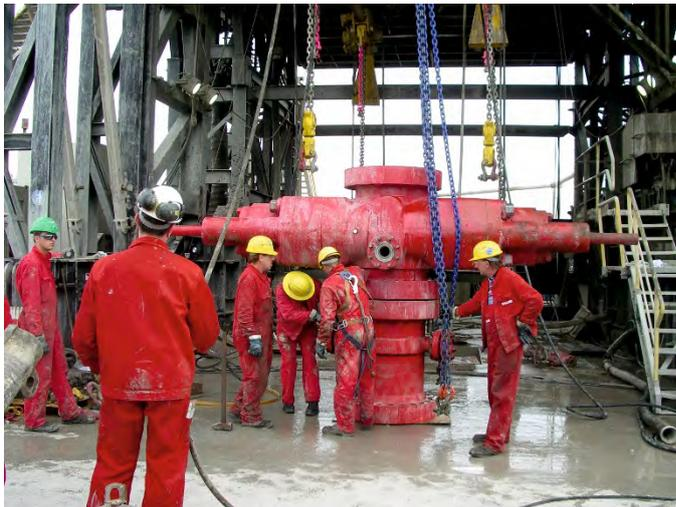
**Abb. 4.1.3** Montage eines Elementes des Blowout Preventers unter der Arbeitsbühne (Foto: Finenko)
