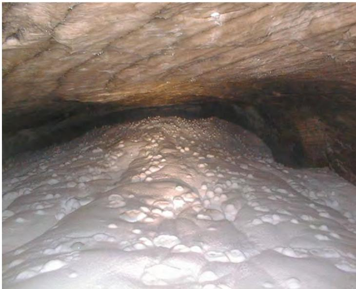
**Abb. 3.1.1** CO<sub>2</sub>-Gletscher nach einem Gasausbruch am 30.08.2003 aus einer Erkundungsbohrung in 950 m Tiefe im Salzgestein
