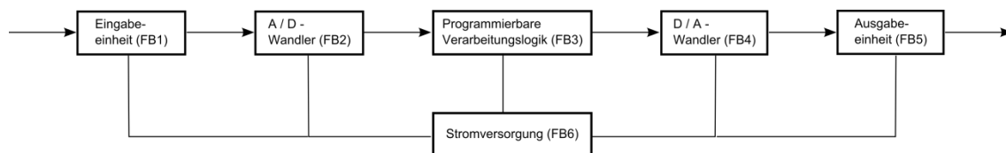
Abb. 5.2 Schematische Darstellung einer programmierbaren Baugruppe (PB)
