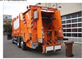
Abbildung I: Sammelfahrzeug mit eingebauten Störstoffdetektoren an der Schüttung.
