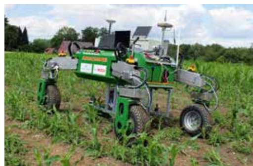
Feldphänotypisierung mit dem BoniRob, entwickelt an der Hochschule Osnabrück
