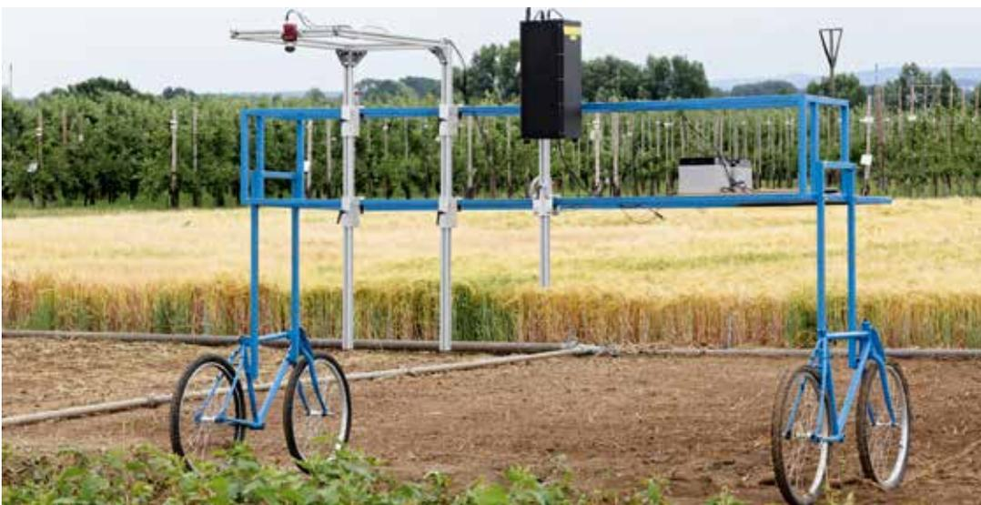
*Die Sensorik des „FieldBike“ besteht aus einer RGB-Kamera (rot, links oben) zur Berechnung des Bedeckungsgrades und einem LIFT-System (schwarz, Mitte oben) zur Registrierung der Pflanzen-Fluoreszenz. Beide Systeme sind batteriebetrieben und vertikal wie horizontal auf dem FieldBike justierbar.*
