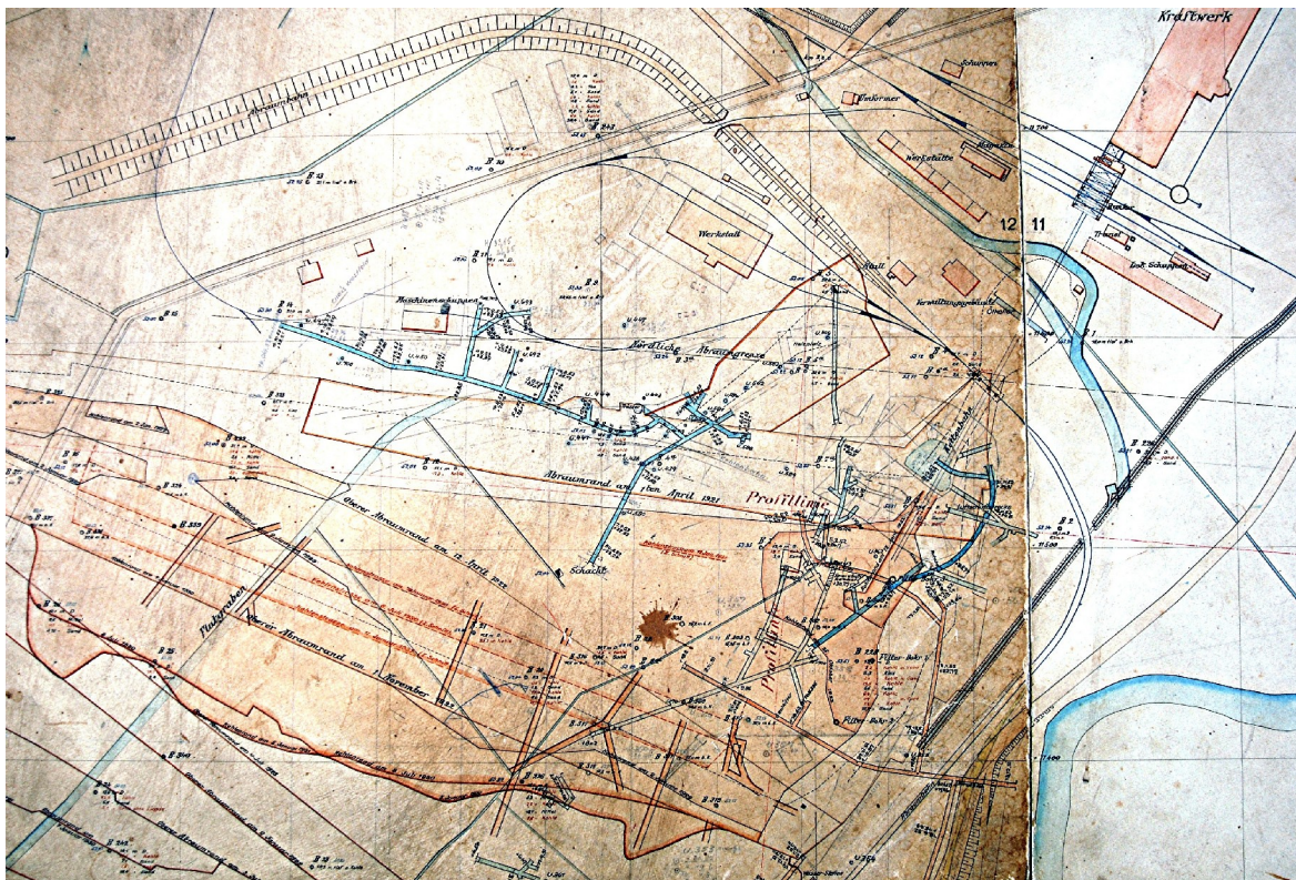
Bild 36: Entwässerungstreckensysteme in der Grube Walter fortgeführt später in der Grube Heck 50
