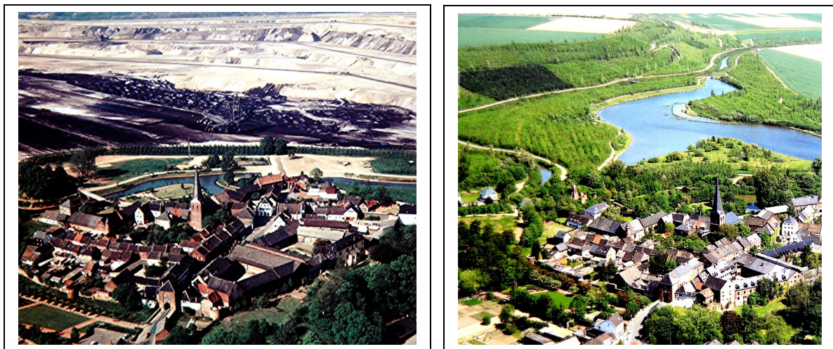
Bild 9: Tagebaue Frimmersdorf Südfeld an der Stadt Kaster während des Abbaus im Jahre 1980 und nach erfolgter Wiedernutzbarmachung mit dem Kasterer See 16
