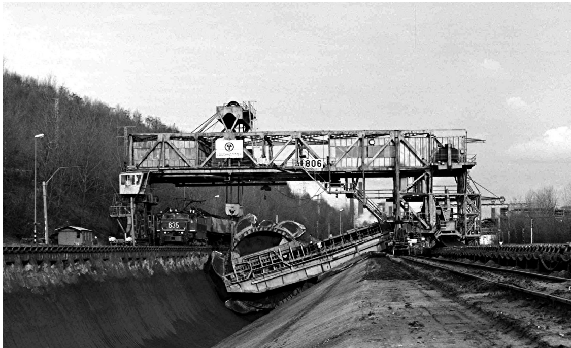
Bild 64: Aufnahmegerät am Rande des Tagebaues Frimmersdorf Südfeld, links die Halde Pielsbusch 91
