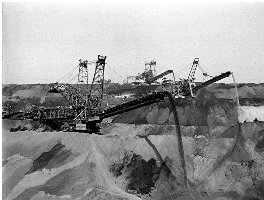
Bild 62: Absetzer Nr. 742, 743 und 744 bei der Verfüllung des ausgekohlten Wiedenfelder Grabens 89
