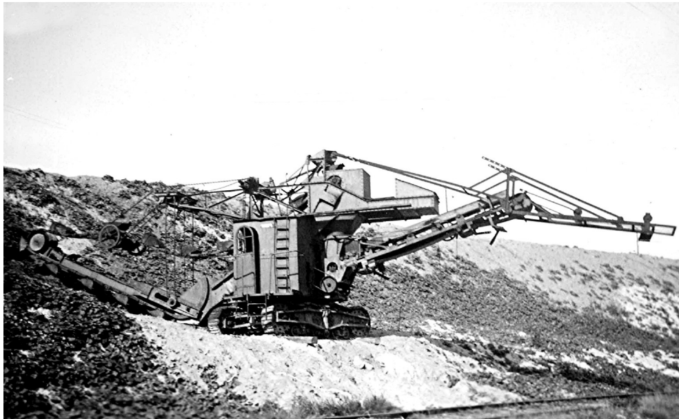
Bild 43: Eimerkettenbagger auf Raupenfahrwerk mit Auslegerband 57
