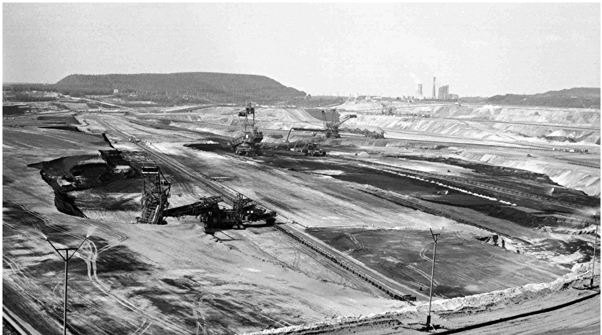
Bild 65: Tagebau Frimmersdorf im Jahre 1977 mit Bandförderung, im Hintergrund die später wieder abgebaggerte Halde Pielsbusch 92
