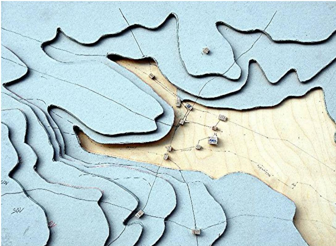
Bild 5: Modell für die Landschaft Neurath mit Höhenscheiben im Bau; die besonders markierten Punkte sind Höhenfestpunkte.
