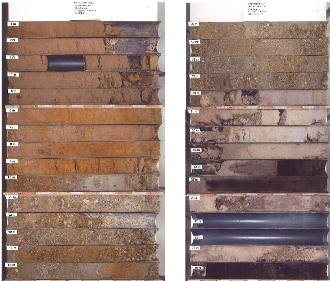
Bild 9: Typisches Profil für den Schichtenaufbau bei Neurath <sup>9</sup>
