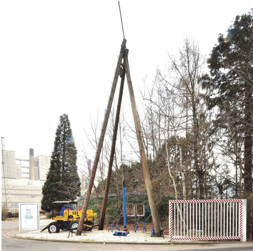
Bild 22: Seilschlagbohrgerät am Eingang des BOWA-Stützpunktes. Mit derartigen Anlagen wurden die ersten Brunnen zur Wasserhebung im Braunkohlenbergbau niedergebracht.
