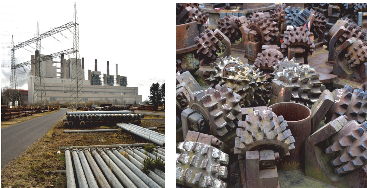
Bild 21: Lagerplatz des BOWA-Stützpunktes vor dem Kraftwerk Neurath, links Rohre und Bohrgestänge, rechts Bohrköpfe
