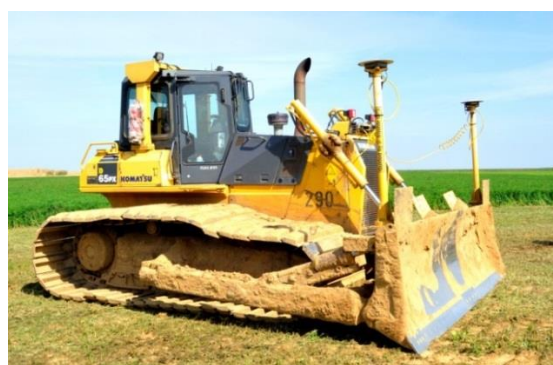
Bild 4: Links: Lössverkipfung zur landwirtschaftlichen Rekultivierung 2 ; rechts: minimaler Bodendruck durch extra breite Kunststoffraupen beim Planieren.
