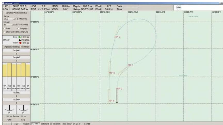
Abbildung 6: Anzeige eines vorgeplanten und an die aktuelle Situation ange-passten Williamson-Turn zur Rückführung bei einem simulierten PoB-Unfall
