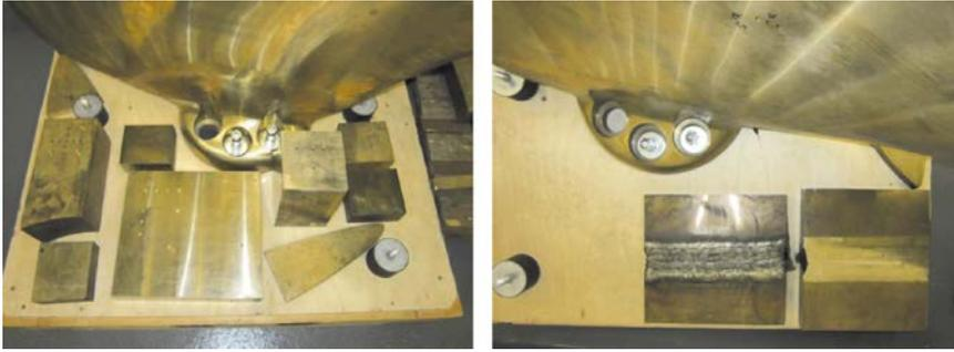
*Abb. 3: Eine Auswahl weiterer Testkörper für die Volumen- (links) und Schweißnahtprüfung (rechts).*
