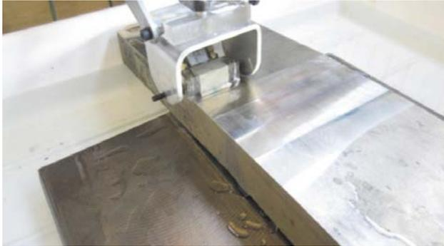
Abb. 12: Prüfung der Schweißnaht mittels Phased-Array-Technik.
