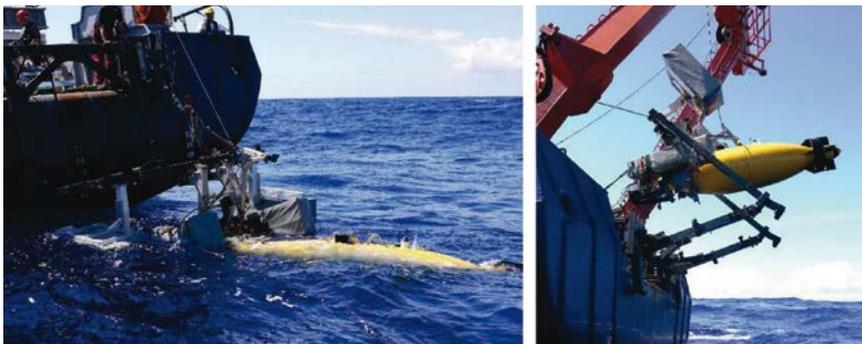
*Links: PreToS wird in den schwimmenden Bergekäfig gezogen; rechts: Bergen nach erfolgreicher Sicherung des AUVs im Bergekäfig mit Schwenkarmen*
