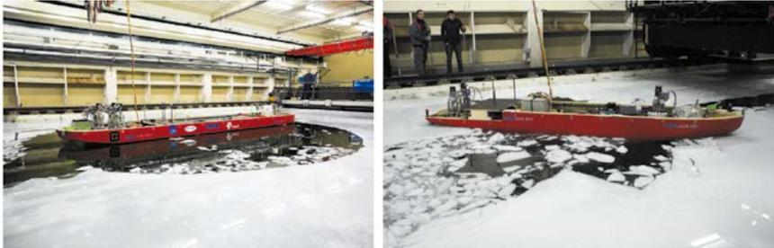
Abbildung 8: Drehkreis im „Station Keeping“ Mode des DP Systems mit dem Bohrschiff (Phase IIA, Run 06100; Photo: Trondlsaksen / Statoil) (links) und Sternmanöver im Joystick Mode des DP Systems mit dem Forschungsschiff (Phase IIA, Run) (rechts), [12]
