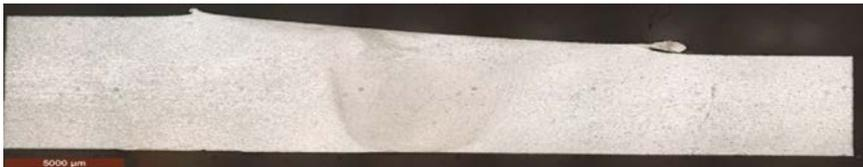
Abbildung 11: Makrographischer Querschliff FSW-Schweißung, Taylored-Plates, mit optimierten FSW Parametern, in Schweißrichtung gesehen (6 / 8 mm)
