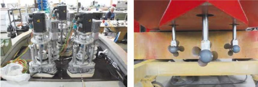
*Abbildung 12: Schiffmodell ausgerüstet mit sechs einheitlichen Ruderpropellern; dargestellt sind die drei Ruderpropellereinheiten des Bugs über (links) und unter Wasser (rechts), [12]*
