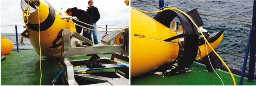
Bei den Ostseeerprobungen im Herbst 2012 wurde das Fahrzeug schwer beschädigt. Das Fahrzeug wurde zum Aussetzen über das Heck angehoben und sollte durch Schwenken des A-Rahmens in die Aussetzposition gebracht werden. Auf halbem Weg zum Heck brach das Stahlseil des Assistenzkranes. Das Fahrzeug fiel aus einer Höhe von ca. 1,5 m mit dem Heck auf das Deck und mit dem Bug auf die Helling.
