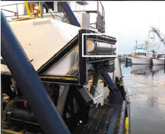
Abb. 4: (a) Einsatz des „HYSUB 20“ ROVs von Steuerbord der M/V Danny C; (b) Die HISEM Sensoreinheit (innerhalb der weißen Umrandung) konnte stossicher hinter dem vorderen ROV-Fänger montiert werden.
