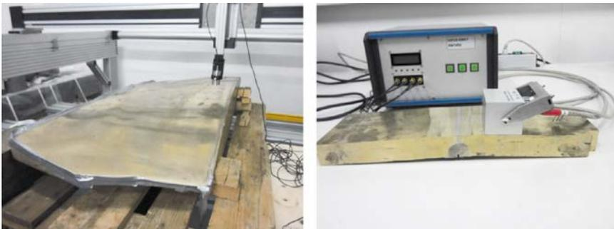
*Abb. 4: Testkörper bei den Untersuchungen zur Oberflächenaufzeichnung mittels Luftschall (links) und der Schweißnahtprüfung mit EMAT (rechts).*
