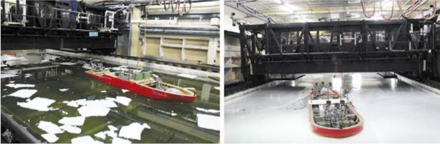
*Abbildung 13: Modell im kabelgebundenem (Phase IIA, Run 07400) (links) und kabellosen Versuchsbetrieb (Phase IIB, Run 09102) (rechts), [12]*
