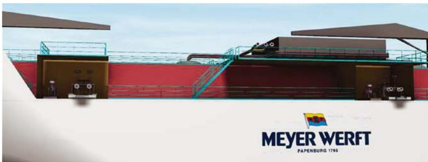
Abb. 3: Übergabestation und Schlauchkran auf der LNG-Barge
