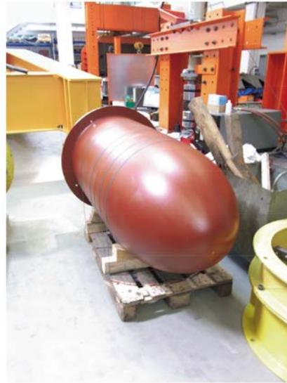
*Bild 11: Seitenhüllen-Modellkörper Versuch-1 im Bau und ein fertiger Bugwulst-Modellkörper (starr)*
