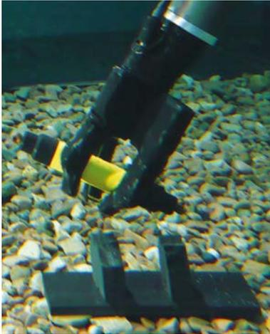
Abbildung 8: Das SeeGrip Greifersystem während der Objekt-handhabung am Orion 7P
