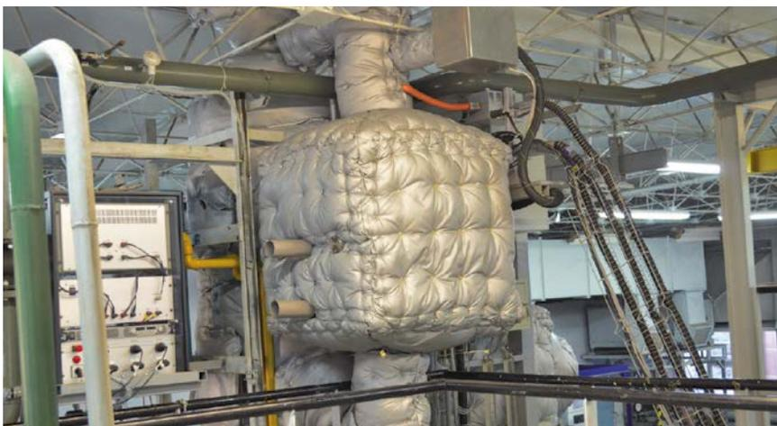
Abbildung 10: Thermisch isolierte Plasmaquelle PQ-MUS im Bypass des Prüfstandsmotors
