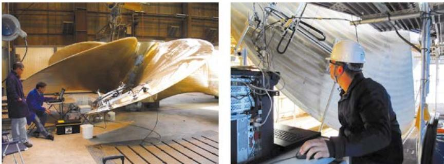
Abb. 18: Ultraschallprüfung an liegenden und montierten Propellern
