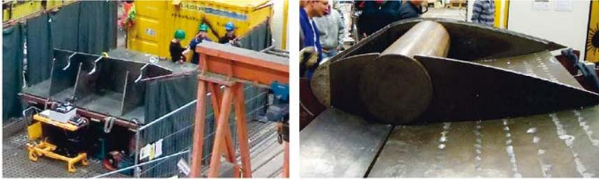
*Abb. 7. Endmontage des Fundament- und Ruderdemonstrators*
